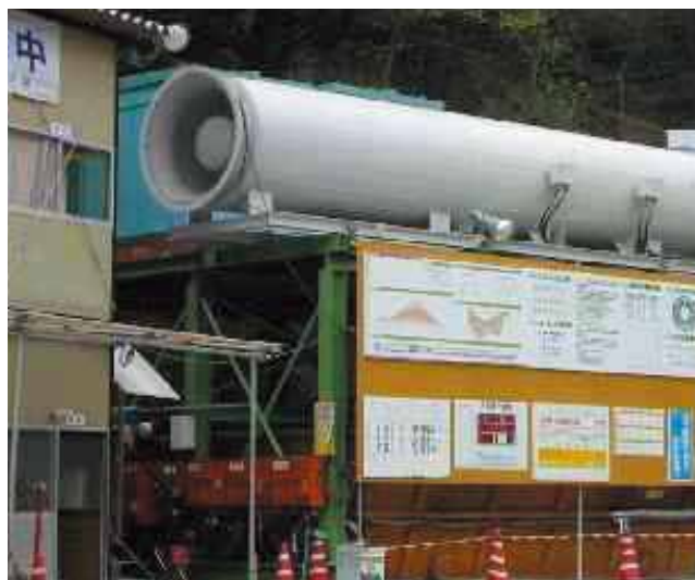
シングル型ビッグ・ログ：モータ直動型（局所送気用等）
