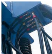
偏心モーメント制御配管部
