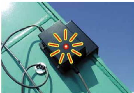
傾斜検出センサ(光(LEDで警報))
