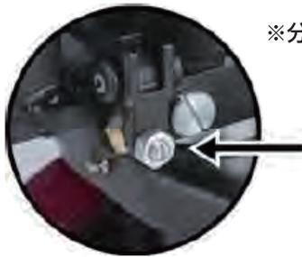
※分解図のD133調整ネジ部の拡大写真です。
