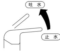
湯水の量はレバーハンドルの上下で調整します。
