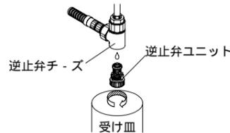
本管止水栓のハンドルを閉じて給水、給湯を止めます。レバーハンドルを左右中央の位置で上げます。ドレンソケットを左に回して逆止弁チーズから取り外し、水を抜いて下さい。（このとき、受け皿を用意して下さい。）完全に水抜きが完了したら、それぞれの水抜き部を閉じて下さい。再通水時には、本管止水栓のハンドルを開いて吐水・止水を2～3回繰り返してから、水抜き部からの漏れの無いことを確認して下さい。
