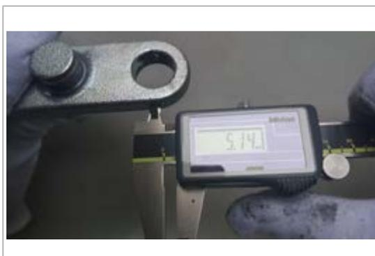
ノギスで計測、穴径5.14mm。
