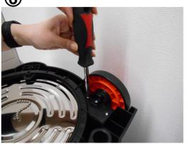
全体を差し込み、付属のビスで固定 します。(プラスドライバ―をご使用 下さい。)
